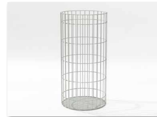
Rundgabione unbefüllt NEU auch befüllt lieferbar Verzinkt, Maschenweite 5 x 20 cm Drahtstärke 6 mm 50 x 200/250/300 cm
